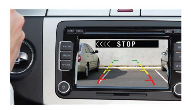
Modulo per visualizzare sul monitor aftermarket il sistema di parcheggio (la zona di arresto e la distanza dall'ostacolo con una risoluzione di 10 cm)
