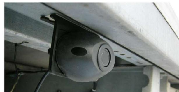
Sistema di parcheggio a filo, 4 sensori digitali con supporti in gomma, raggio d'azione 3 metri, specifico per mezzi commerciali
