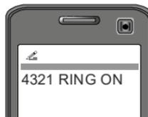
La funzione abilita la periferica a telefonare ad i numeri in rubrica in fase di allarme
