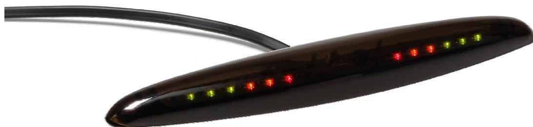
*Nuovo display a led da posizionare all'interno dell'abitacolo, che in maniera chiara e veloce permette di visualizzare la distanza minima dall'ostacolo rilevata dai sensori posteriori (35-180cm).*
