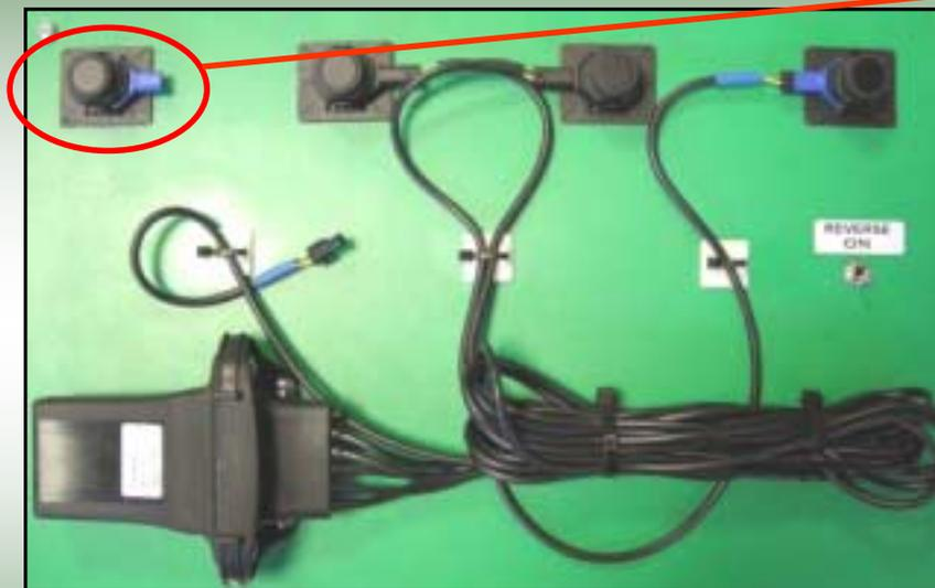
Esempio B: sensore difettoso di una centralina REAR
